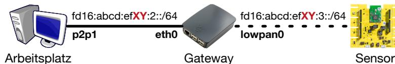
Abbildung 1: Aufbau eines minimalen Sensornetzwerks ohne Routing.
