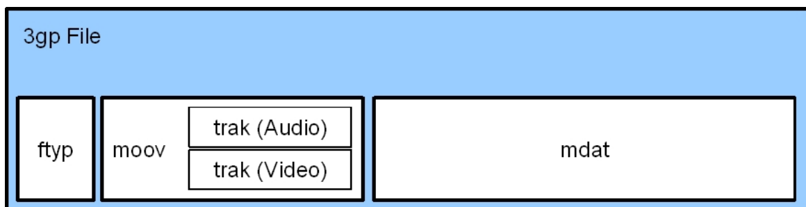
Abbildung 3.6: typische 3gp Dateistruktur
