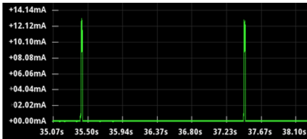
Abbildung 4.18.: Duty-Cycling mit RTC als Wakeup-Trigger
